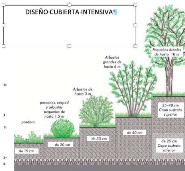
En cubiertas sin pendiente puede realizarse un aljibe controlado a una profundidad de hasta 5 cm para alimentar la capa vegetal con humedad, sin tener que instalar sistemas de riego aparte. Este tipo de riego por capilaridad y difusión va en función del espesor de la capa vegetal. Permite el crecimiento de plantas, arbustos y árboles de considerable altura en capas vegetales de reducido grosor, para disminuir las sobrecargas de las cubiertas y construcciones estructurales del edificio.
