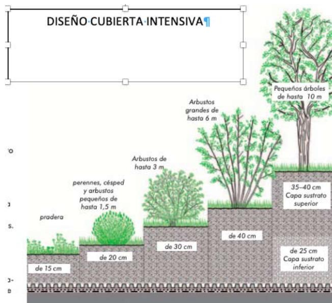
En cobertes sense pendent es pot realitzar un aljub controlat a una profunditat de fins 5 cm per a alimentar la capa vegetal amb humitat, sense tenir que instal·lar sistemes de reg a banda. Aquest tipus de reg per capil·laritat i difusió va en funció de l'espessor de la capa vegetal. Permet el creixement de plantes, arbustos i arbres de considerable altura en capes vegetals de reduït gruix, per a disminuir les sobrecàrregues de les cobertes i construccions estructurals de l'edifici.
